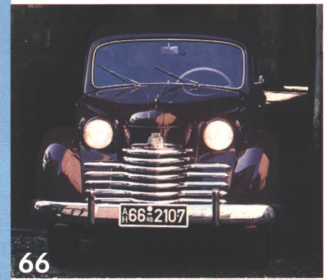
Der Olympia war das erste Serienauto mit selbsttragender Ganzstahl-Karosserie
