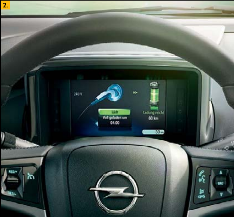
2. Das Ladedisplay zeigt den aktuellen Ladestatus und die daraus resultierende Batteriereichweite an.
