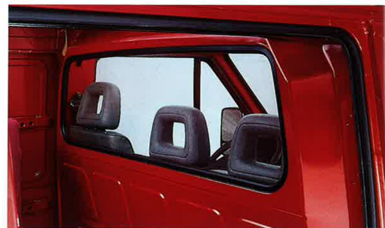
Die Trennwand mit Glasscheibe schirmt Sie sicher ab.
