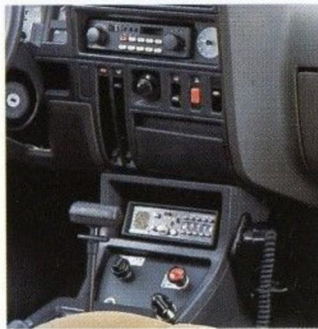
Links unten: Die Verkabelungen der Dachaufbauten sind durch Reißverschlüsse in der Deckenverkleidung leicht zugänglich. Rechts unten: Das Funkgerät und die Bedienelemente der Warnanlage können nachträglich in die Mittelkonsole integriert werden. Eine entsprechende Vorrüstung ist bereits ab Werk als Sonderausstattung erhältlich.
