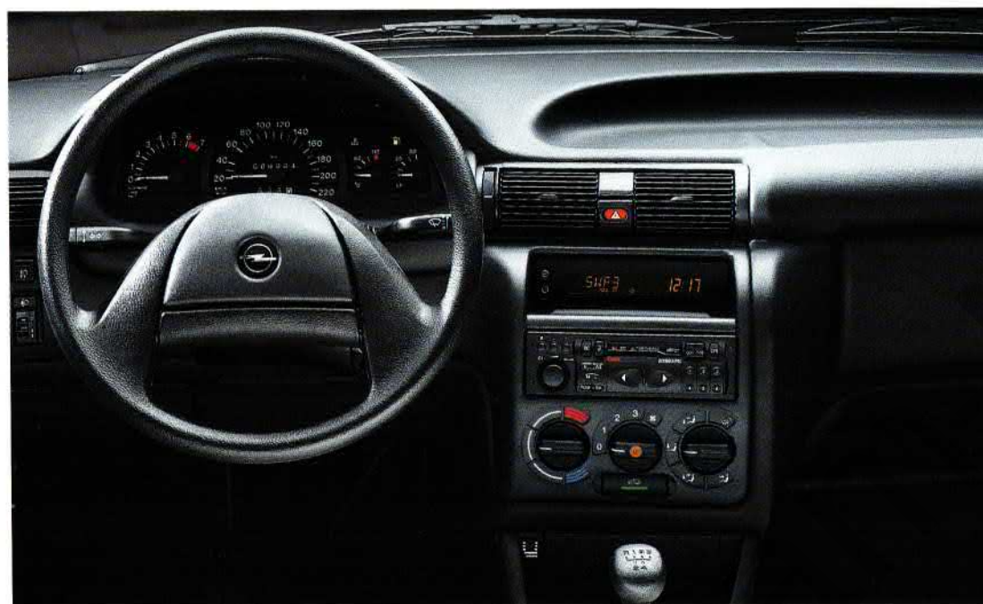
Das formschöne und funktionelle Astra-Cockpit: Alle Bedienelemente sind für den Fahrer gut erreichbar platziert, alle Instrumente nach dem Durchlichtprinzip gleichmäßig ausgeleuchtet. Das Dual-Info-Display zeigt Uhrzeit, Datum und die Radiofunktionen an.
