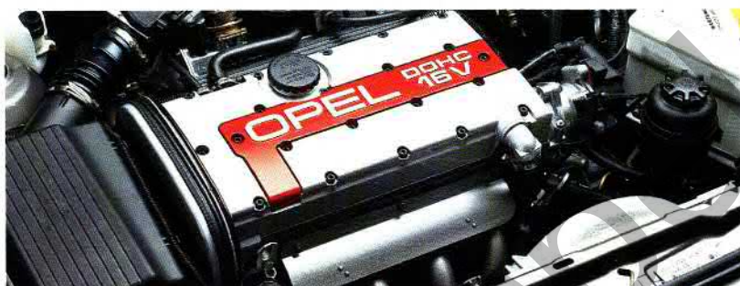
Das 2.0i-16V-Triebwerk des Astra GSi 16V mit 110 kW (150 PS).
