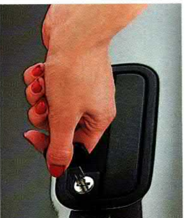
Zentralverriegelung mit Diebstahlsicherung und abschließbarem Handschloßfach. Verriegelt Türen, Tankdeckel und Kofferraum.
