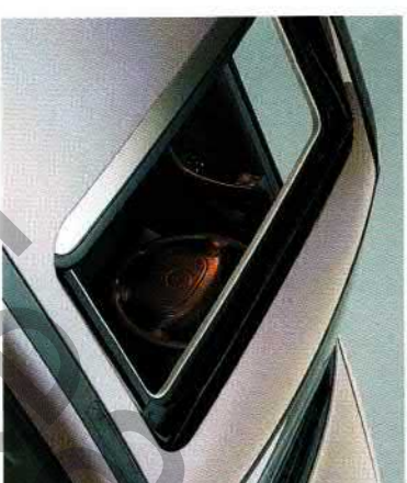
Schiebe-/Hebehaub. Getöntes Glaskareldach mit eingebauter Blende und Entlüftungseinrichtung.
