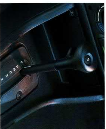
Elektronisch gesteuerte Opel 4-Gang-Automatik mit drei Fahrprogrammen.
