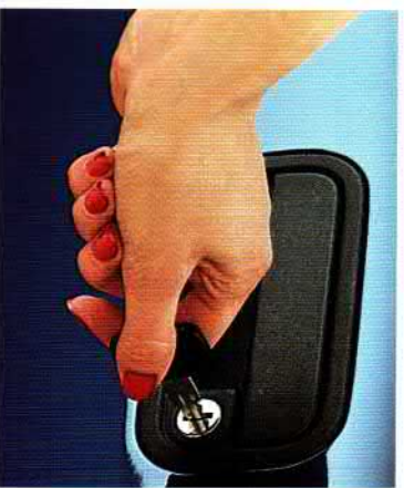
Zentralverriegelung mit Diebstahlsicherung und abschließbarem Handschuhfach. Verriegelt Türen, Tankdeckel und Kofferraum/Caplockraum.
