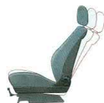
Körpergerechte Voll-schaumsitze vorn mit integrierter Sitzrampe und stufenlos einstellbarer Rückenlehne.
