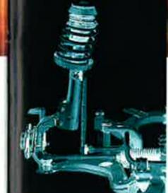
*Die Vorderradaufhängung: McPherson-Federbeine mit DSA-Charakteristik für spurstabiles Bremsen in kritischen Situationen.*
