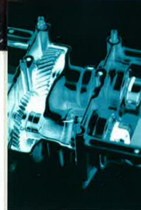
*Gegenläufige Ausgleichswellen reduzieren im 2.0 16V ECOTEC (100 kW/136 PS) Vibrationen und Geräusche.*
