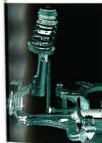
*Die Vorderradaufhängung: McPherson-Aluminium-Federbeine mit DSA-Charakteristik für spurtreues Handling und Bremsen in kritischen Situationen.*
