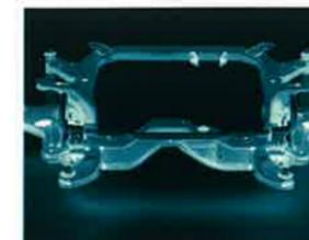
*Der Fabrschemel mit 6 Entkoppelungspunkten optimiert Fahrkomfort und Handling.*
