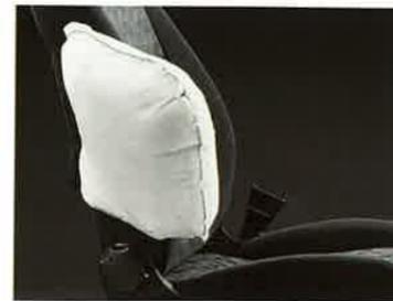
Diese serienmäßigen Komponenten bieten ein hohes Maß an passiver Sicherheit: Die Opel Full Size Front- und Seitenairbags für Fahrer und Beifahrer sowie das von Opel patentierte PRS-System, das bei einem Aufprall die Pedalbox auskuppelt und so die Beine des Fahrers schützt.
