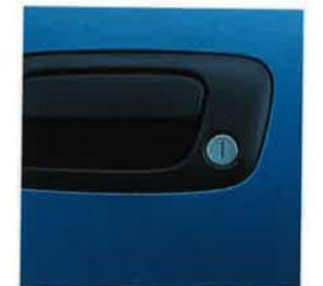
**Freidrehende Schließzylinder** an Türen und Zündung gehören zur neuen serienmäßigen Schloßgeneration. Auf jeden Öffnungs- oder Startversuch ohne richtigen Schlüssel reagieren die Schlösser mit dem völligen Freidrehen der Schließzylinder in ihrem Gehäuse.
