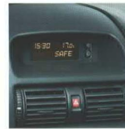
**Die Radios mit dem separaten Display.** Alle Opel Radios sind nur in Verbindung mit dem Triple-Info-Display bzw. dem Bordcomputer funktionsfähig. Das macht sie für Langfinger uninteressant. Und schließlich sagt an jedem Opel Radio eine blinkende Leuchtwanddiode: „Hier gibt es nichts zu holen.“
