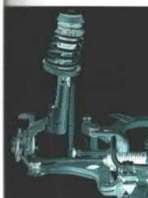
*Die Vorderradaufhängung: McPherson-Aluminium-Federbeine mit DSA-Charakteristik für spurtreues Handling und Bremsen in kritischen Situationen.*
