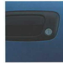
**Freidrehende Schließzylinder** an Türen und Zündung gehören zur neuen serienmäßigen Schloßgeneration. Auf jeden Öffnungs- oder Startversuch ohne richtigen Schlüssel reagieren die Schösser mit dem völligen Freidrehen der Schließzylinder in ihrem Gehäuse.
