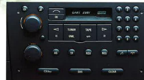
*Übersichtliches Doppel-DIN-Format: Radio CART 2007, die Kombination aus Radio, Kassettenspieler und integriertem D-Netz-Telefon (serienmäßig im Omega Edition 2000).*
