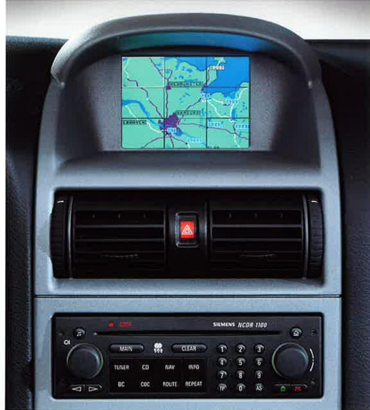
**Siemens Stereo-CD-Radio NCDR 1100** mit integriertem Navigationssystem und 4-fach-CD-Wechsler im Handschuhfach, auf Wunsch gegen Mehrpreis auch mit Farbmonitor.
