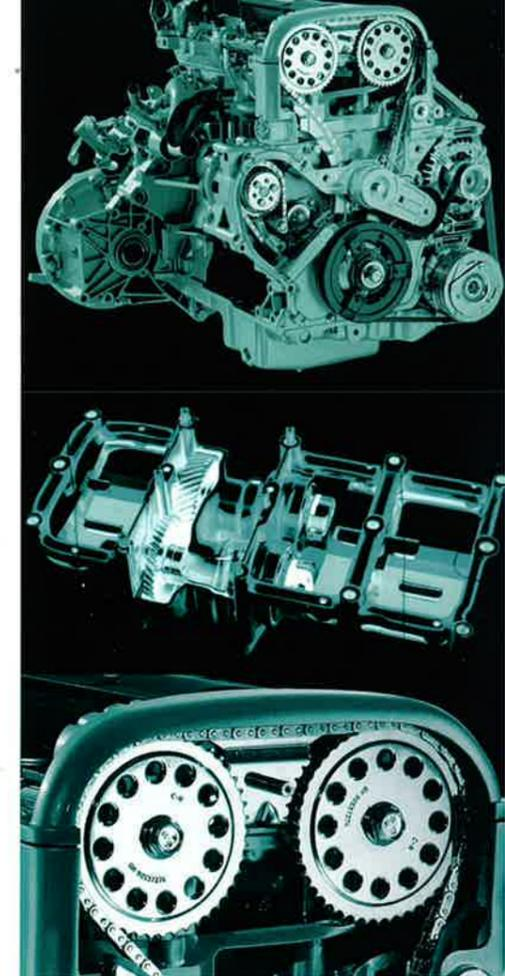
Zum sportlich-dynamischen Auftritt gehört der souveräne Antritt, und den gibt es im Coupé gleich in mehreren Ausführungen, angefangen beim 1.8 16V ECOTEC-Motor mit 92 kW (125 PS). Hightech pur bietet der neue 2.2 16V ECOTEC-Motor mit Zylinderkopf und Kurbelgehäuse aus Leichtmetall und einer Leistung von 108 kW (147 PS). Zwei Ausgleichswellen sorgen hier für besonders ruhigen Motorlauf.
