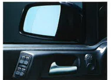
Komfort, für den Sie nur einen Finger brauchen: die elektrischen Fensterheber vorn und hinten (beim 3-Türer nur vorn) mit Einklemmschutz durch Sicherheits-Elektronik. Beide Außenspiegel sind elektrisch einstell- und beheizbar.
