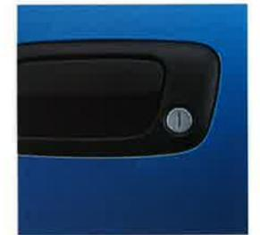
**Frei drehende Schließzylinder** an Türen und Zündung gehören zur neuen, serienmäßigen Schlossgeneration. Auf jeden Öffnungs- oder Startversuch ohne richtigen Schlüssel reagieren die Schlösser mit dem völligen Freidrehen der Schließzylinder in ihrem Gehäuse.
