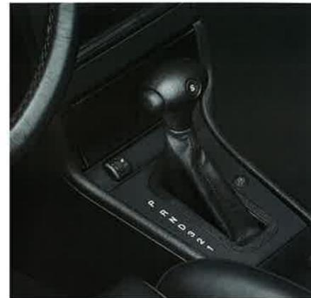
Elektronisch gesteuerte 4-Gang-Automatik (nur mit 2.2 16V ECOTEC®-Motor).
