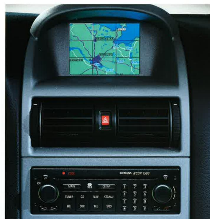
Siemens Stereo-CD-Radio NCDR 1500 mit integriertem D-Netz-Telefon, Mobilitäts-Service OnStar, Navigationssystem und 4-fach-CD-Wechsler im Handschuhfach, auf Wunsch gegen Mehrpreis auch mit Farbdisplay.
