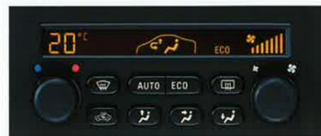
Die Klimatisierungsautomatik, die Komfortvariante der Klimaanlage mit Temperaturvorwahl (serienmäßig im Turbo).
