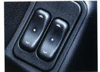
*Komfort, für den Sie nur einen Finger brauchen: die elektrischen Fensterheber vorn mit Einklemmschutz durch Sicherheits-Elektronik.*
