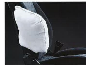
*Diese serienmäßigen Komponenten bieten ein hohes Maß an passiver Sicherheit: die Full Size Front- und Seitenairbags für Fahrer und Beifahrer, aktive Kopfstützen vorn sowie das von Opel patentierte PRS-System, das bei einem Aufprall die Pedalbox auskuppelt und so die Beine des Fahrers schützt.*
