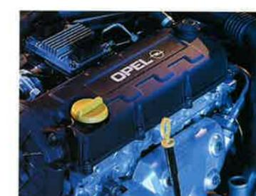
*Hightech, die sparen hilft. Dank der vollelektronisch geregelten Hochdruck-Verteilerpumpe und den zentral im Aluminium-Zylinderkopf angeordneten Hochpräzisionsdüsen holt der ECOTEC®-Turbodiesel-Direkteinspritzer deutlich mehr Kilometer aus jedem Liter Kraftstoff.*
