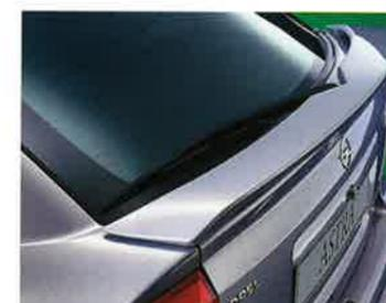
*Optimierte Aerodynamik. Mit dem serienmäßigen Heckspoiler, reduzierten Front-Einlassöffnungen und der wirbelvermindernden Unterbodenverkleidung konnte der Luftwiderstandsbeiwert des Astra ECO 4 auf  $c_w = 0,28$  gesenkt werden.*
