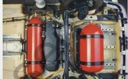
Einzigartige und platzsparende Unterflurweise der Tankanlage, die mit Spannbändern am Unterboden befestigt ist. Zwischen den zwei Gastanks ist der zusätzliche 14-Liter-Berzinstromk installiert.
