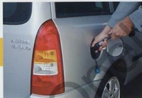
Der Erdgasbetankungsvorgang ist vergleichbar mit dem Benzin tanken und genauso einfach und sicher. Die Erdgasfüllkupplung wird auf den CNG-Einfüllstutzen aufgesetzt, gesichert und schon erfolgt die Betankung.
