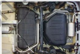
Die gesamte Tankanlage wird durch Unterbodenverkleidungen geschützt.
