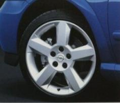
Ungewöhnliche Ansichten. Die speziell für den Turbo entwickelten Leichtmetallräder 7½ J x 17 im 5-Speichen-Design mit Reifen der Größe 215/40 R 17.
