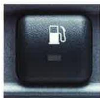
Der Erdgasbetankungsvorgang ist vergleichbar mit dem Benzintanken und genauso einfach und sicher. Die Erdgasfüllkupplung wird auf den CNG-Einfüllstutzen aufgesetzt, gesichert und schon erfolgt die Betankung. Geht der Gasvorrat zur Neige, können Sie das System einfach mit dem Funktionsknopf am Armaturenbrett auf Benzinversorgung umschalten
