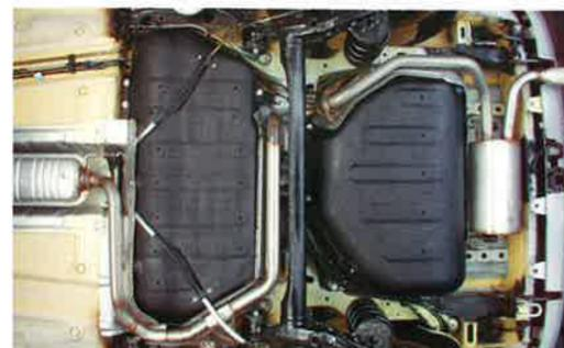
Die gesamte Tankanlage wird durch Unterbodenverkleidungen geschützt
