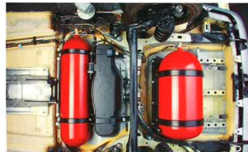
Einzigartige und platzsparende Unterflurbauweise der Tankanlage, die mit Spannbändern am Unterboden befestigt ist. Zwischen den zwei Gastanks ist der zusätzliche 14-Liter-Benzinnottank installiert
