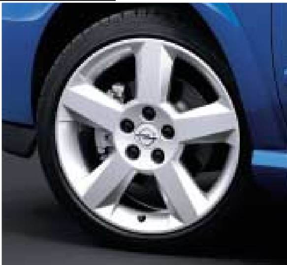
Ungewöhnliche Ansichten. Die speziell für den Turbo entwickelten Leichtmetallräder 7 1/2 J x 17 im 5-Speichen-Design mit Reifen der Größe 215/40 R 17.
