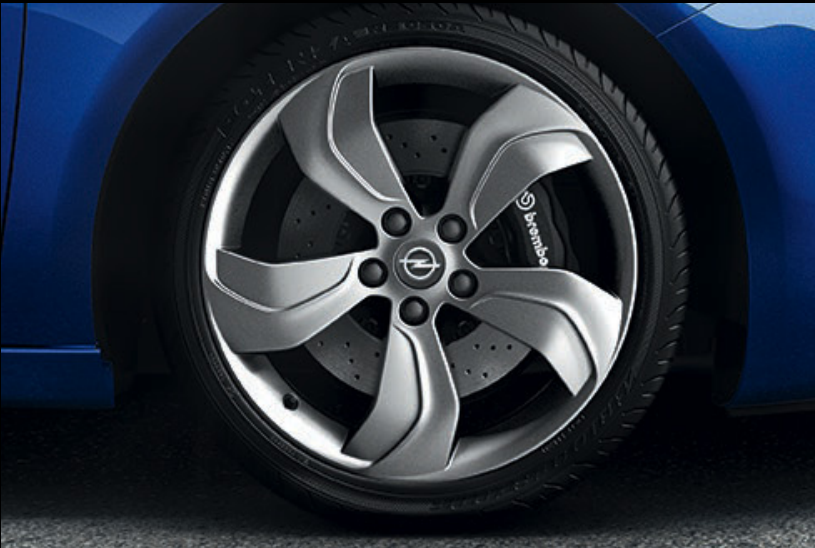
Leichtmetallrad. 8 J x 19 im OPC Design, Reifen 245/40 R 19 (RQN, Serie).
