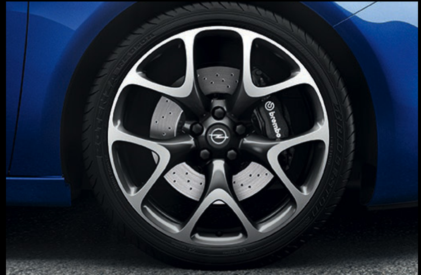
Leichtmetallrad. 8½ J x 20 im 5-Y-Speichen-OPC Design, BiColor, Reifen 245/35 R 20 (R01, Option).
