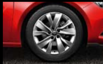
Leichtmetallrad im „5-Doppelspeichen“-Design, 7½ J x 18 mit Reifen 235/50 R 18. (RQH)
