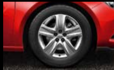
Designrad inkl. Abdeckung im „5-Speichen“-Design, 7 J x 17 mit Reifen 235/55 R 17. (PWT)
