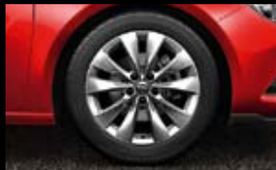
Leichtmetallrad im „10-Speichen“-Design, 7½ J x 18 mit Reifen 235/50 R 18. (RQJ) Serie bei INNOVATION
