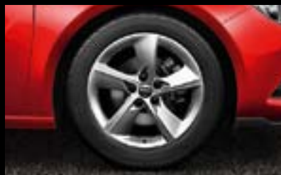
Leichtmetallrad im „5-Speichen“-Design, 7½ J x 18 mit Reifen 235/50 R 18. (RSZ) Serie bei BiTurbo
