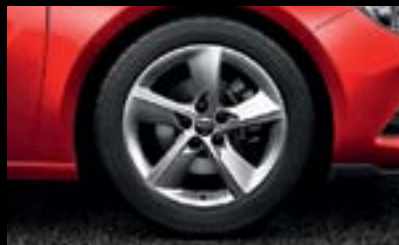
Leichtmetallrad im „5-Speichen“-Design, 7½ J x 18 mit Reifen 235/50 R 18. (RSZ) Serie bei BiTurbo.
