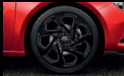
Leichtmetallrad im „7-Speichen“-Design in Schwarz, 8½ J x 20 mit Reifen 245/40 R 20. (RTH)
