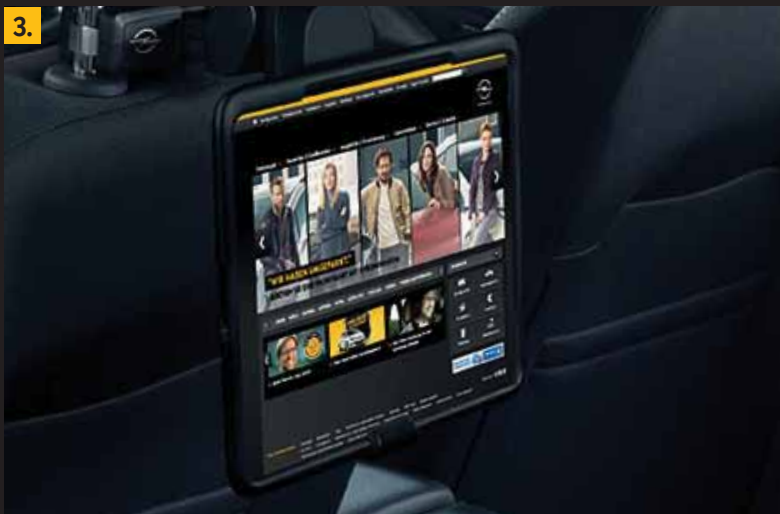
3. iPad Halter. Mit den speziellen Haltern für iPad und iPad mini ist für beste Unterhaltung auf den Rücksitzen gesorgt. Der Halter ist von Hoch- auf Querformat drehbar. Zum Betrachten von Videos wird er in hoher Position, zum Lesen und Schreiben in niedriger Position montiert.
