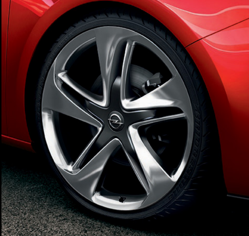
Leichtmetallrad im „5-Sternspeichen“-Design, 8½ J x 20 mit Reifen 245/40 R 20. (RQ9)
