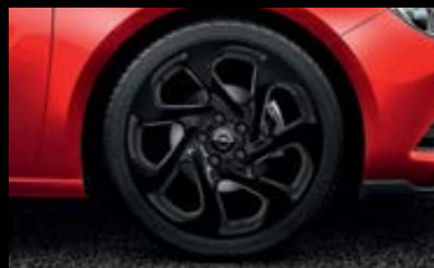
20"-Leichtmetallrad im „7-Speichen“-Design in Schwarz, 8½ J x 20 mit Reifen 245/40 R 20. (RTH)
