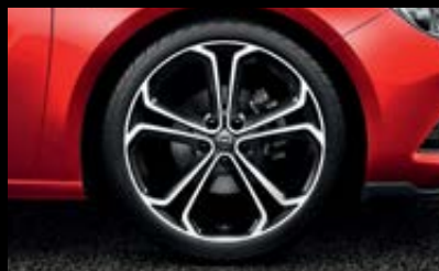
20"-BiColor-Leichtmetallrad im „5-Doppelspeichen“-Design, 8½ J x 20 mit Reifen 245/40 R 20. (RQA)
