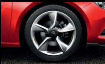
19"-Leichtmetallrad im „5-Speichen“-Design, 8 J x 19 mit Reifen 235/45 R 19. (RT8)
