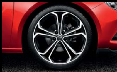
20"-Leichtmetallrad (5 Doppelspeichen), BiColor, 8½ J x 20 mit Reifen 245/40 R 20. (RQA)
