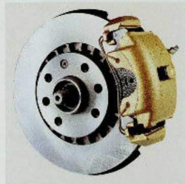
Der Calibra hat ein diagonales Zweikreisbremssystem mit Bremskraftverstärker und Bremskraftregler. Die Bremsbeläge sind, der Umwelt zuliebe, selbstverständlich asbestfrei.
