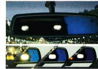
Das ist neu! Ein mitdenkender **Innenspiegel**, 1704741. Ein lichtempfindlicher Sensor registriert, wenn Sie geblendet werden und blendet automatisch ab. Mit einem Schalter läßt sich die Empfindlichkeit des Sensors in 2 Stufen regeln.
