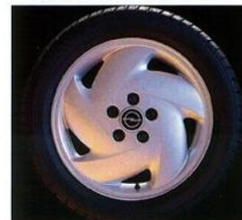
Die Leichtmetallräder (6 x 16) (speziell für den Calibra turbo) sind mit Reifen der Größe 205/50ZR16 ausgestattet.
