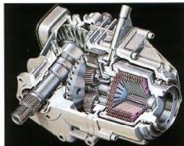
Die Visco-Kupplung ermöglicht eine variable Kraftübertragung von der Vorder- auf die Hinterachse. Dadurch kann der Calibra turbo 4x4 auch bei Nässe und Schnee optimal reagieren.
