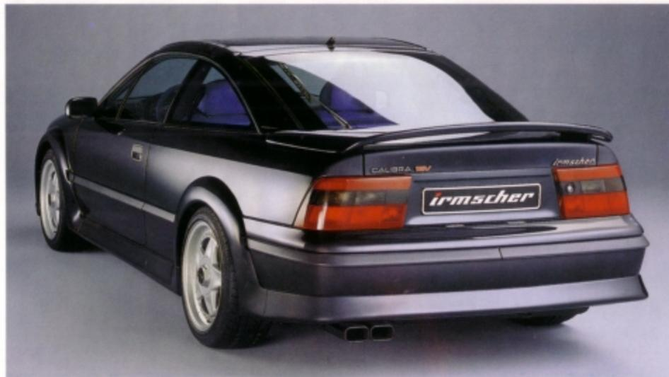
Irmischer Calibra Sydney mit LM-Felgen im Stern-Design, Nachschalldämpfer und Heckflügel.
