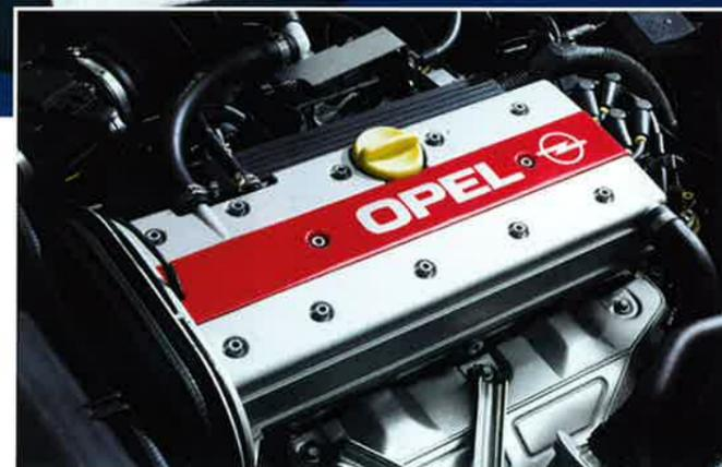
100 kW (136 PS) aus 1998 cm<sup>3</sup> Hubraum, exzellente Laufleistungen und ein äußerst sparsamer Verbrauch, der mit 7,8 l auf 100 km im Euromix schon heute die strengen Abgasnormen von 1996 erfüllt, zeichnen den neuen 2.0-16V-ECOTEC-Motor aus.
