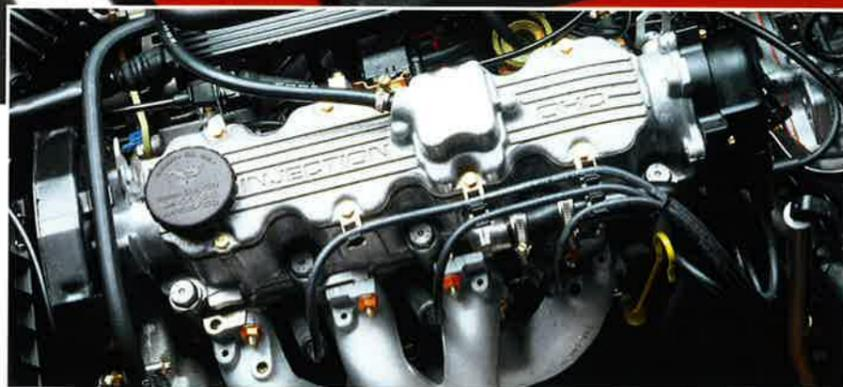
Der 2.0i-Motor mit 85 kW (115 PS) wird von der Bosch-Motronic M 1.5 gesteuert und überwacht.
