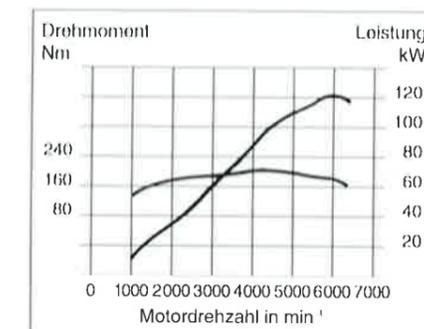
Souveräne Durchzugskraft: Der Vierventiler erreicht bei 4200 min<sup>-1</sup> sein maximales Drehmoment von 227 Nm. Im Bereich zwischen 1600 und 6400 min<sup>-1</sup> stehen beachtliche 180 Nm zur Verfügung.
