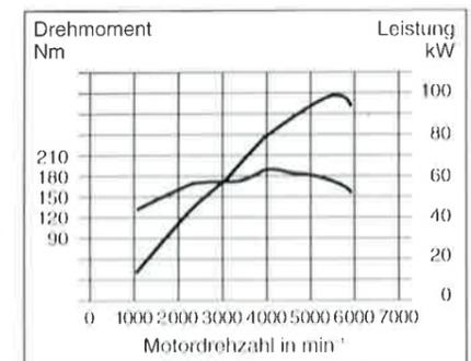
Das vom System Syntec 56 elektronisch gesteuerte 2.0-16V-ECOTEC-Triebwerk zeigt einen ausgewogenen Drehmomentverlauf, der für die lauffröhige und komfortable Kraftentfaltung dieses modernen Motors sorgt. Das maximale Drehmoment von 185 Nm liegt bei 4 000 min<sup>-1</sup>.
