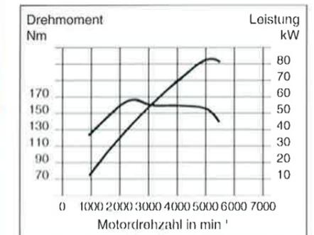
Mit 85 kW (115 PS) entwickelt der 2.0i-Motor sein maximales Drehmoment (170 Nm) bei 2600 min<sup>-1</sup>.
