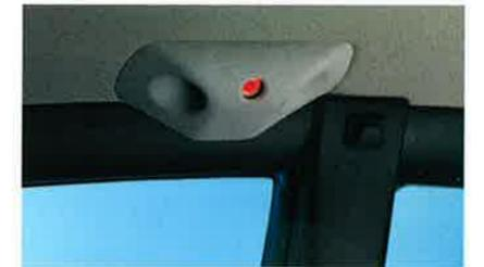
*Diebstahlwarnanlage mit Ultraschallsensoren.*
