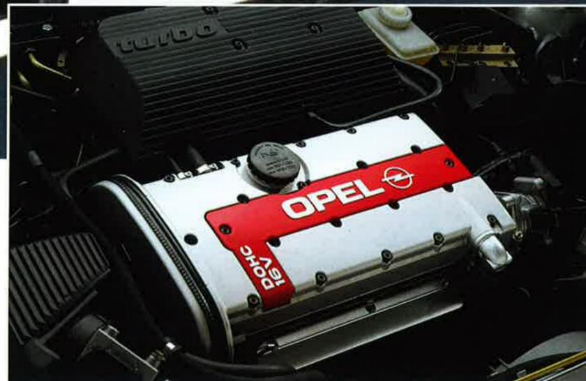
2.0i-16V-Turbomotor mit 150 kW (204 PS). Ein kompakter und daher leichter Turbo mit enormen Beschleunigungswerten und vorbildlicher Elastizität.
