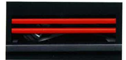
Calibra-Rundumschutz-System. Optimierter Insassenschutz durch integrierte Doppel-Stahlrohrverstärkungen in den Sei-
