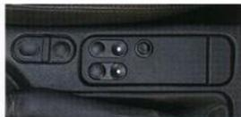
Hoher Standard in den Sondermodellen Calibra 2.0 und 16V Color Selection: elektrische Fensterheber vorn mit Tippfunktion und Einklemmschutz (bei Calibra V6 und Calibra Turbo Grundausstattung).
