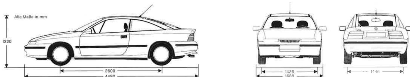
**Karosserie:** Optimaler Schutz für Passanten: runde Konturen, keine scharfen Kanten und breite, verformbare Stoßfänger. Computerberechnete, selbsttragende Ganzstahlkarosserie unter Anwendung der „Finite-Elemente-Methode“ mit vorprogrammierten Verformungszonen an Front
