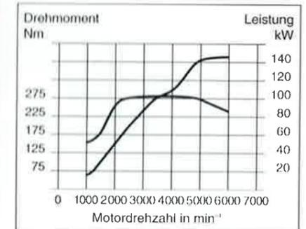
Ein hohes Grunddrehmoment verkürzt die Ansprechzeit des Motors. Die Maximalleistung von 150 kW (204 PS) liegt bei 5600 min<sup>-1</sup>, Drehmoment sind 280 Nm bei nur 2400 min<sup>-1</sup>.
