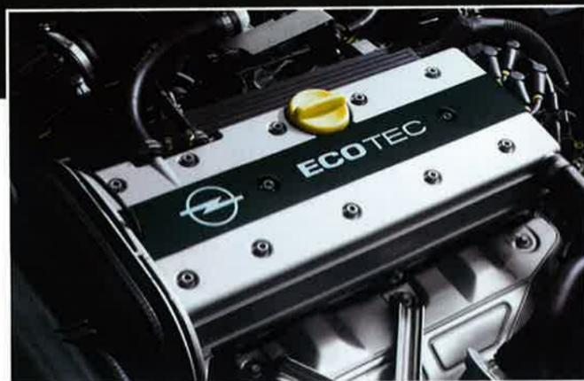
100 kW (136 PS) aus 1 998 cm<sup>3</sup> Hubraum, exzellente Laufleistungen und ein äußerst sparsamer Verbrauch, der mit 7,8 l auf 100 km im Euromix schon heute die strengen Abgasnormen von 1996 erfüllt, zeichnen den neuen 16V-ECOTEC-Motor aus.
