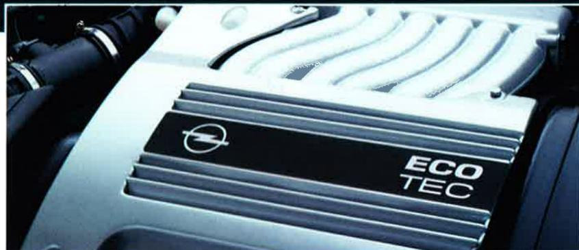
V6-ECOTEC-Motor. (170 PS). Ein Motor der neuen Generation. Das kompakte High-Tech-Triebwerk mit 2.5 Liter Hubraum, 24 Ventilen und 125 kW. Charakteristik – also hohes Drehmoment schon bei niedrigen Drehzahlen –, sowie viele konsequent durchdachte Detaillösungen bestimmen seinen starken, sauberen und leisen Auftritt.
