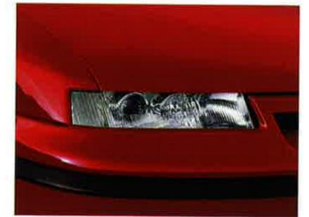
Ellipsoid-Scheinwerfer – eine optische und technische Besonderheit des Calibra. Extrem schmale Scheinwerfer, die durch die Kombination aus Reflektor und Linse maximale Lichtausbeute, geringes Streulicht und scharfe Hell-Dunkel-Abgrenzung erzielen.
