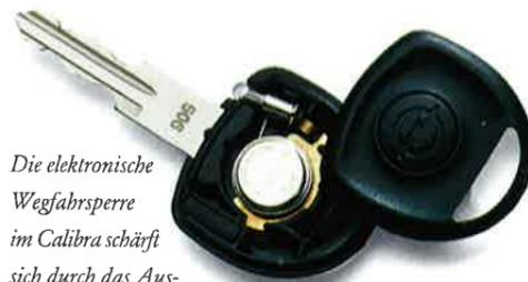
Die elektronische Wegfahrsperrung im Calibra schließt sich durch das Ausschalten der Zündung sofort und vollautomatisch. Durch einen Eingriff ins Motormanagement erfüllt die Opel Wegfahrsperrung der 3. Generation auch zukünftig die Anforderungen der Versicherer und ist absolut manipulationsicher.
