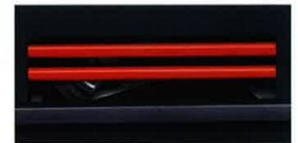
Calibra-Rundumschutz-System. Optimierter Insassenschutz durch integrierte Doppel-Stahlrohrverstärkungen in den Seiten-
