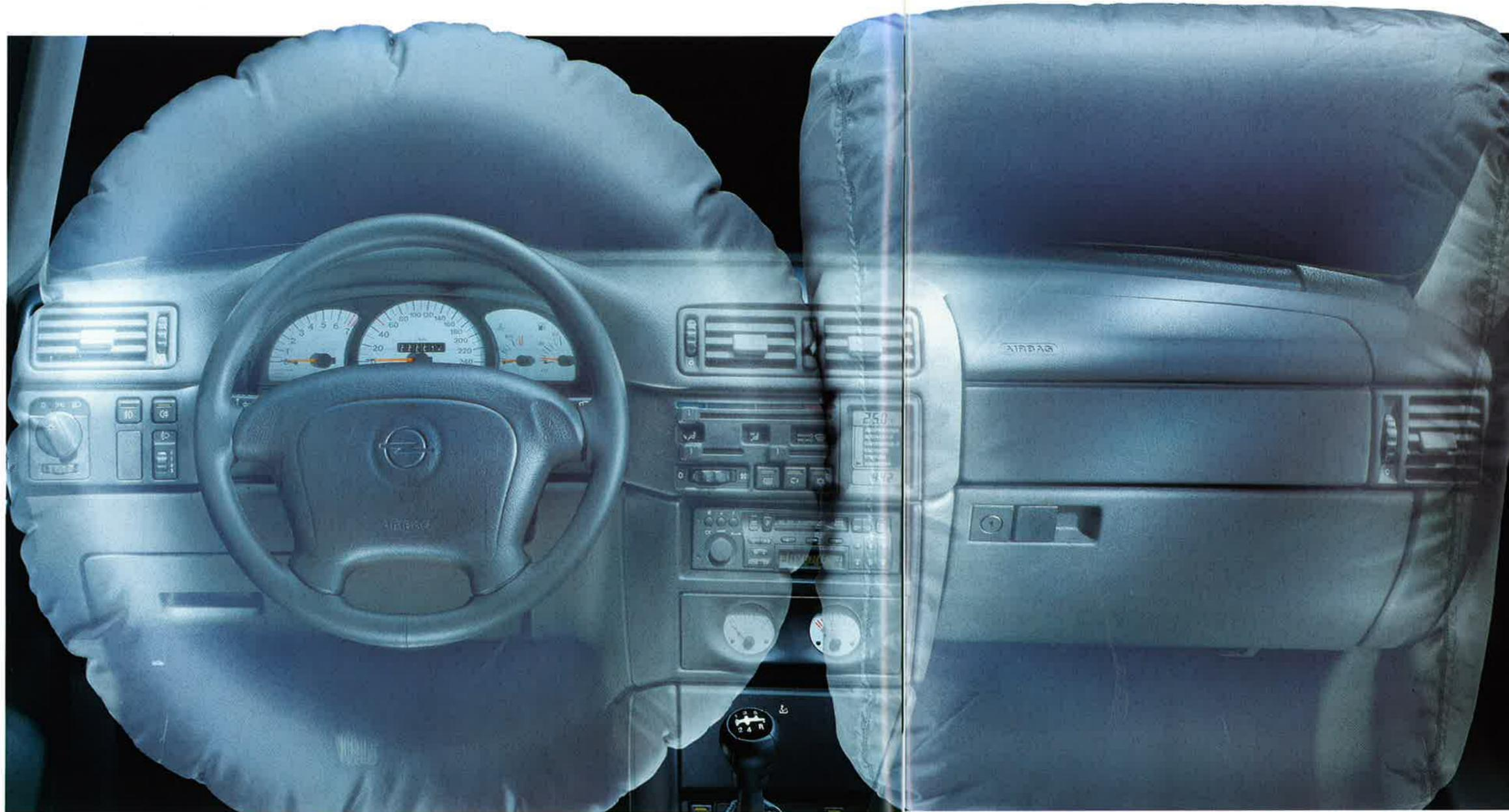
*Opel Full Size Airbag. Im Bruchteil der Zeit, die Sie für einen Augenaufschlag benötigen, entfaltet sich der Airbag. Eine Reihe von Crash-Tests und Versuche unter extremen Bedingungen, wie*
