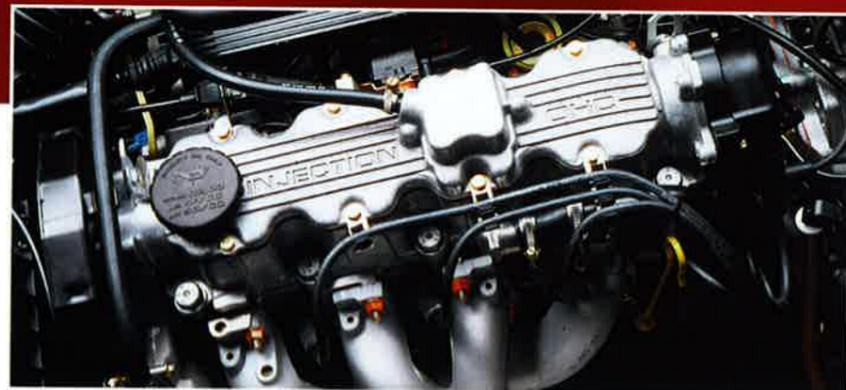
Der 2.0-Motor mit 85 kW (115 PS) wird von der Bosch-Motronic M 1.5 gesteuert und überwacht.
