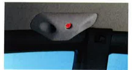
Diebstahlwarnanlage mit Ultraschallsensoren.
