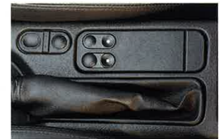
Elektrische Fensterheber. Die Fensterheber funktionieren mit elektronischer Sicherheitslogik.
