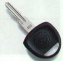
*Die elektronische Wegfahrsperre im Calibra schließt sich durch das Ausschalten der Zündung sofort und vollautomatisch. Durch Eingriff in die Motor-*
