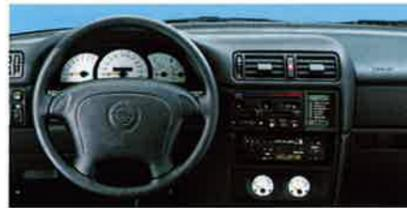
und Berechnung der Unfallstärke innerhalb von 20 ms den Zündimpuls aus. Nach 150 ms ist der gesamte Vorgang abgeschlossen. Zusätzliche Stahlstreben an der Lenksäule verhindern das Eindringen der Lenksäule in den Fahrgastraum.
