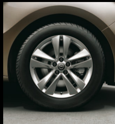
Leichtmetallrad 6 J x 16, Reifen 195/60 R 16. 4
