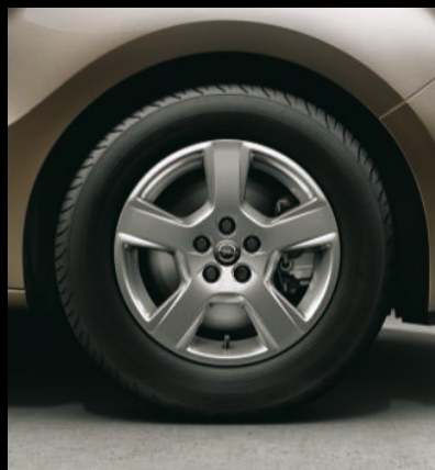
Leichtmetallrad 6 J x 15, Reifen 195/65 R 15. 3
