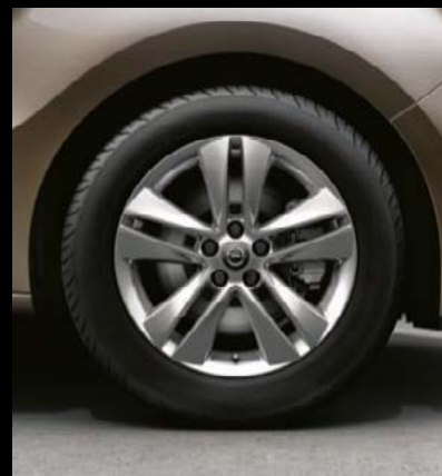
Leichtmetallrad 6 J x 16, Reifen 195/60 R 16. 4
