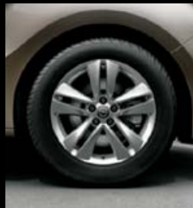
Leichtmetallrad 6 J x 16, Reifen 195/60 R 16. 4
