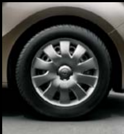
Stahlrad 6 J x 16, Reifen 195/60 R 16. 2
