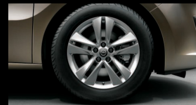
Leichtmetallrad 6 J x 16, Reifen 195/60 R 16. 8
