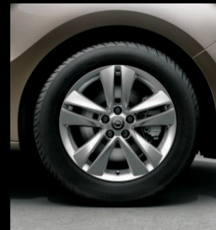
Leichtmetallrad 6 J x 16, Reifen 195/60 R 16.
