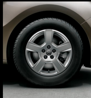
Leichtmetallrad 6 J x 15, Reifen 195/65 R 15. 1,2
