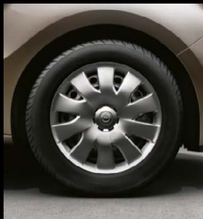
Stahlrad 6 J x 16, Reifen 195/60 R 16. 2
