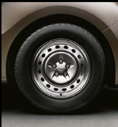
Stahlrad 6 J x 15, Reifen 185/65 R 15. 1
