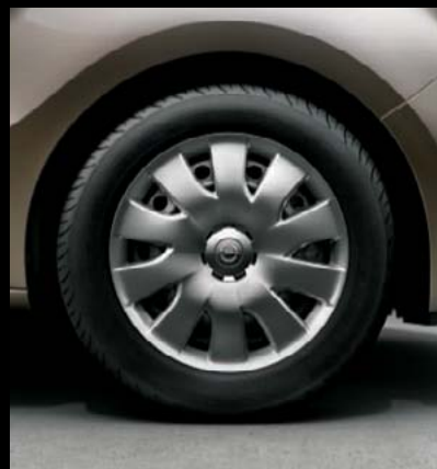
Stahlrad 6 J x 16, Reifen 195/60 R 16. 2
