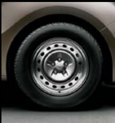
Stahlrad 6 J x 15, Reifen 185/65 R 15. 1
