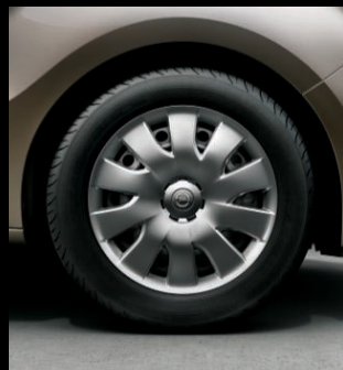
Stahlrad 6 J x 16, Reifen 195/60 R 16. 1
