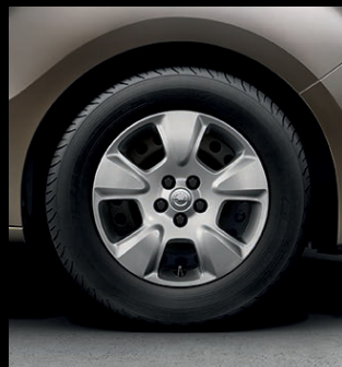
Stahlrad 6 J x 15, Reifen 195/65 R 15. 1
