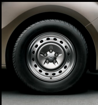
Stahlrad 6 J x 15, Reifen 185/65 R 15. 1
