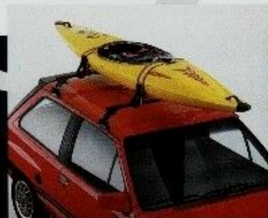
Bootträger , 17.32.424, mit 4 verstellbaren Stützen. Nur in Verbindung mit Basisträger.
